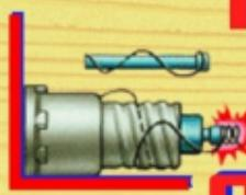
Применять в аппаратах защиты электросетей не калиброванные плавкие вставки (скрутки проволоки, «жучки»)
